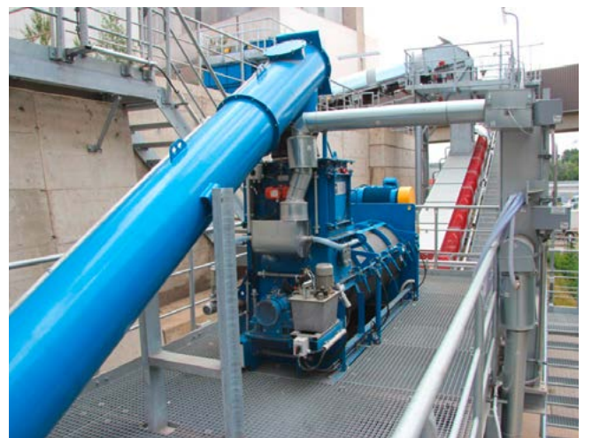
用于加湿粉煤灰的连续式搅拌设备
