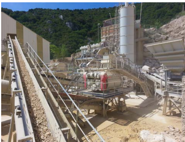
配备底部自卸装置的 Combimix 系统
