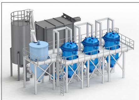
Abb. 1 Die einstufige Anlage mit drei Kerzenfiltern (dunkelblau) und Anmischbehältern (vorne) sowie Precoatierung, Big Bag-Entleerstation und Vorratssilo für Perlite (hinten)
