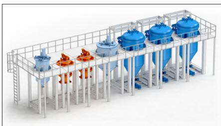
Abb. 2 Die zweistufige Anlage mit drei Kerzenfiltern (dunkelblau), Kuchenwäsche, einem Rührkessel, zwei Tellerdruckfiltern (orange) und einem Waschwassertank
