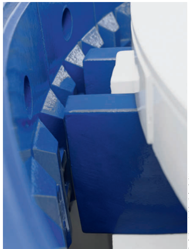
3 Der Spalt zwischen den Schlaghämmern und der Ringpanzerung kann auf nur 5mm eingestellt werden • The gap between the impact hammers and the anvil ring can be reduced down to 5mm
